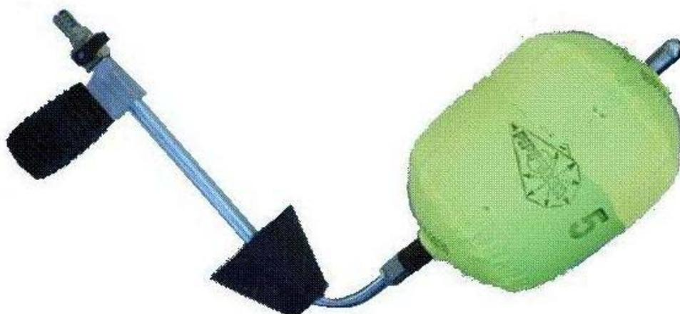
Palloni otturatori per basse pressioni, montato su tubo zincato fino Ø 175, con camera d'aria, fodera in poliestere gommato antistatico, tappo conico scorrevole in gomma. Completo di manometro con protezione in gomma e quadrante con indici delle pressioni di gonfiaggio (dal Ø 50 a Ø 1000).
